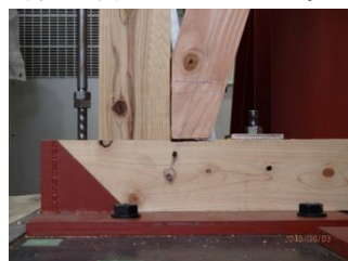
写真2 釘打ち筋かい
